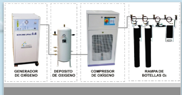
Ejemplo esquemático de una planta de llenado de botellas de oxígeno
